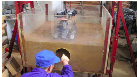
图 9 隧道开挖模拟试验
