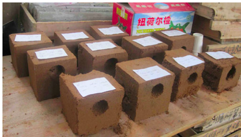
图 7 开挖试验后小尺度隧道模型
