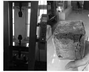
图4 WDW4204 万能试验机与压碎后的试块
