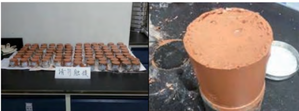
图 4 脱模前后的试样
