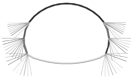
图 3 锁脚锚管倾角工况
