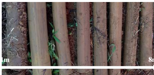
图 1 南阳原位试验场地土层岩芯
