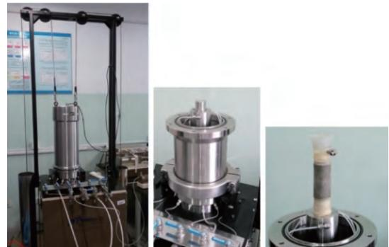
图1 GTS 高压动静三轴试验仪及装样图
