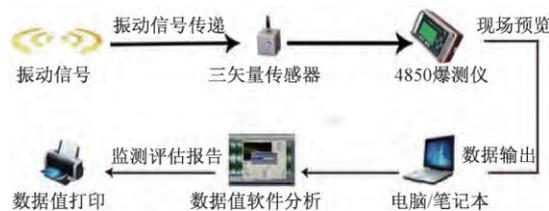
图 4 爆破测振仪工作示意图
