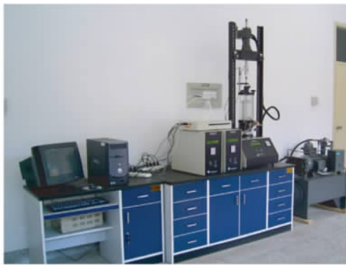
图 2 自动循环加载三轴测试系统
