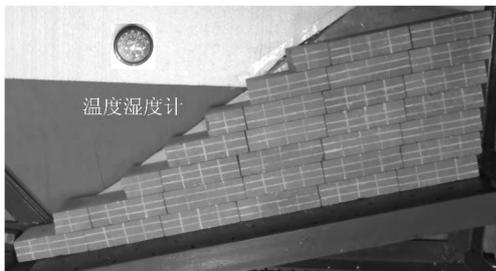
图3 二维岩质边坡模型
