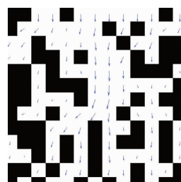
图 8 渗流场内局部速度矢量图
