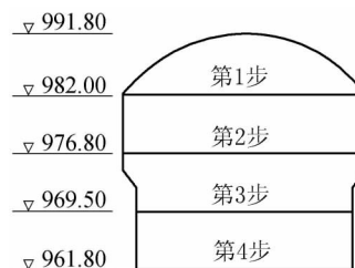
图3 地下厂房开挖顺序示意图(单位:m)
