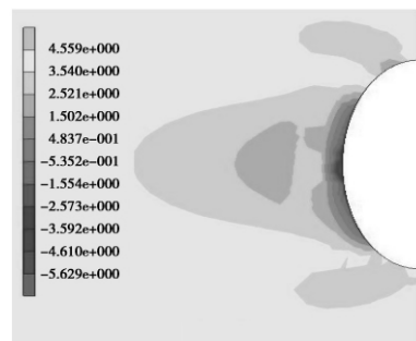
图 6 内压 10 MPa 时腔体周边可靠度云图
