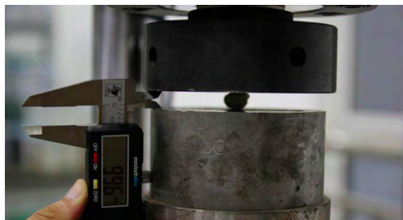
图 3 珊瑚颗粒直径测试
