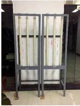
图 1 MXG-1 型毛细管水上升高度仪
