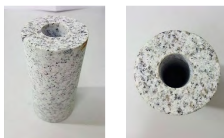
图 2 花岗岩厚壁圆筒试样
