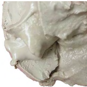
图 7 纤维素 PAC 的海水泥浆泥皮 Fig.7 Filter loss of seawater slurry under cellulose PAC
