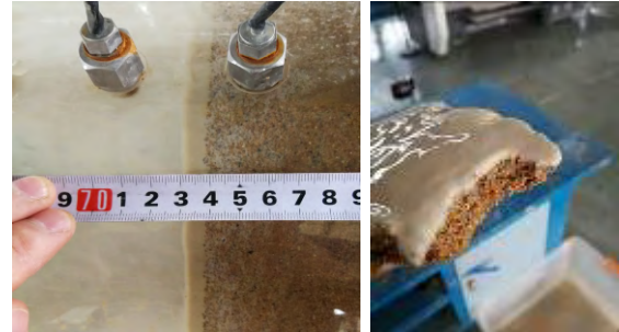
图 16 测量泥皮厚度 Fig.16 Measuring slurry thickness
