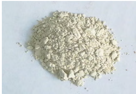
图 1 钠基膨润土样 Fig.1 Sodium bentonite
