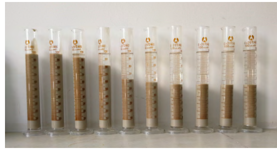
图 4 不同膨润土掺量下海水泥浆胶体率 Fig.4 Colloidal rate of seawater slurry under different bentonite contents
