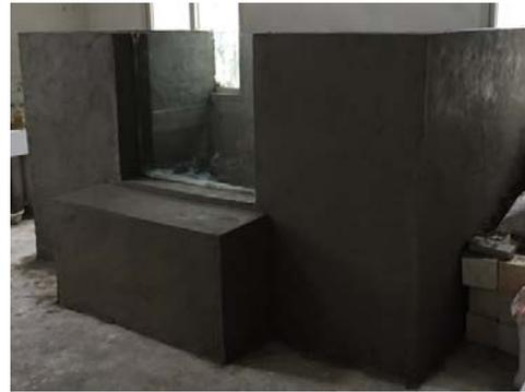
图 1 模型试验槽
