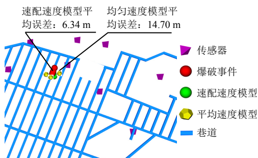
图 7 基于均匀速度模型和数据库动态速配速度模型爆破事件定位结果对比图
